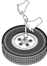
Figure 1 Le système de forces exercé, par l'intermédiaire d'une clé, sur l'érou d'une roue.
