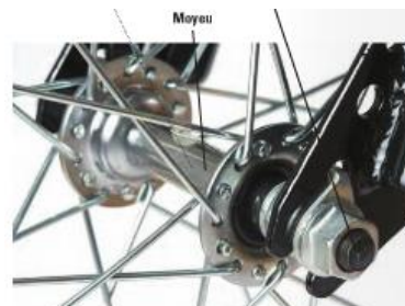
b) Pour une roue libre, l'arbre est fixe et le moyeu est tournant.
