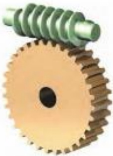
b) Un système de roue dentée et de vis sans fin (denture droite).
