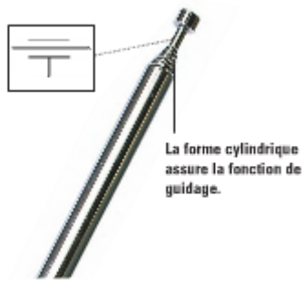
Figure 24 Le guidage en rotation et en translation des sections d'une antenne télescopique.
