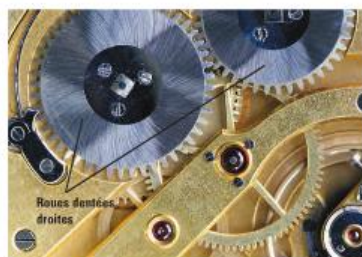
Figure 34 a Le système d'engrenage d'une montre.
