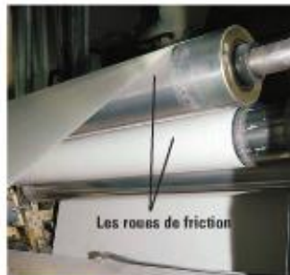
Figure 28 a Une presse à imprimer comporte plusieurs rouleaux qui fonctionnent comme des roues de friction.
