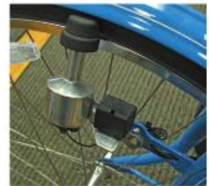
Figure 28 b Une dynamo de bicyclette fonctionne selon le principe des roues de friction.
