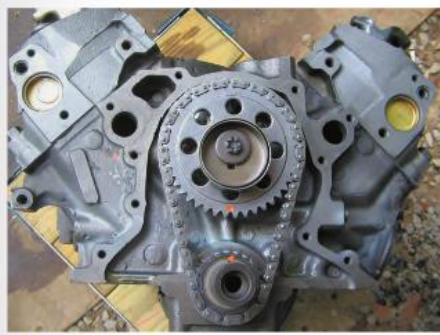
Figure 37 Le système de chaîne et de roues dentées d'un moteur.
