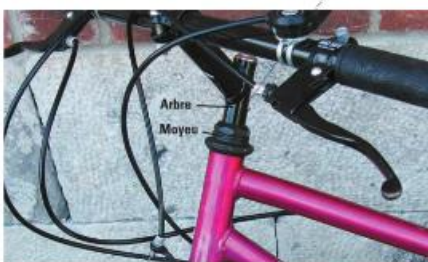
a) Pour un guidon, le moyeu est fixe et l'arbre est tournant.
