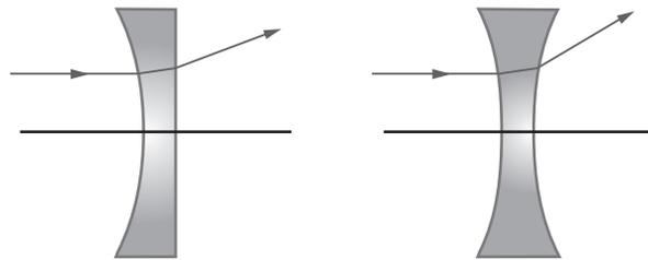
Pour le rayon incident sur les deux lentilles illustrées ci-dessus, l'angle d'incidence est le même à la première face, et donc l'angle de réfraction aussi. Cependant, à la seconde face, l'angle d'incidence est plus grand pour la lentille biconcave et donc l'angle de réfraction aussi. Ainsi, la déviation du rayon est plus grande pour la lentille biconcave que pour la lentille plan-concave.
