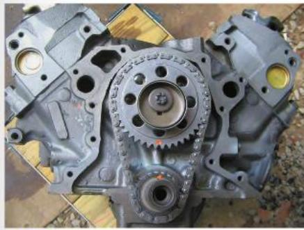
Figure 37 Les systèmes de chaîne et de roues dentées d'un moteur.
