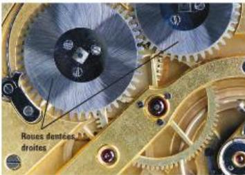
Figure 34 a Le système d'engrenage d'une montre.
