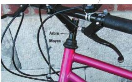
a) Pour un guidon, le moyeu est fixe et l'arbre est tournant.
