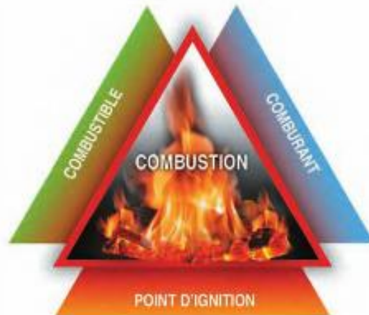
Figure 107 Les trois facteurs du « triangle de feu » doivent être réunis pour qu'il y ait combustion.
