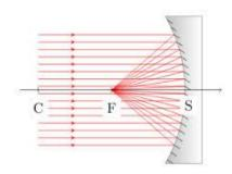
L'ABERRATION SPHÉRIQUE est un défaut optique. Les rayons parallèles à l'axe principal ne se focalisent pas en un seul foyer. La forme idéale pour éviter l'aberration sphérique est celle d'un miroir parabolique.
