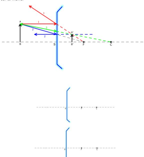
IMAGES FORMÉES PAR LES MIROIRS COURBES : Pour trouver l'image d'un objet placé devant un miroir sphérique on utilise les rayons principaux.
