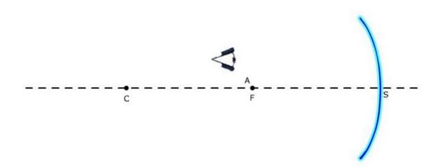
LES RAYONS PRINCIPAUX : Ces rayons vont nous permettre de tracer l'image d'un objet devant un miroir courbe.
